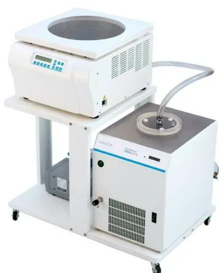
ScanSpeed 40 у системі MaxiVac Alpha. Насос і холодовловлювач — окремо.
