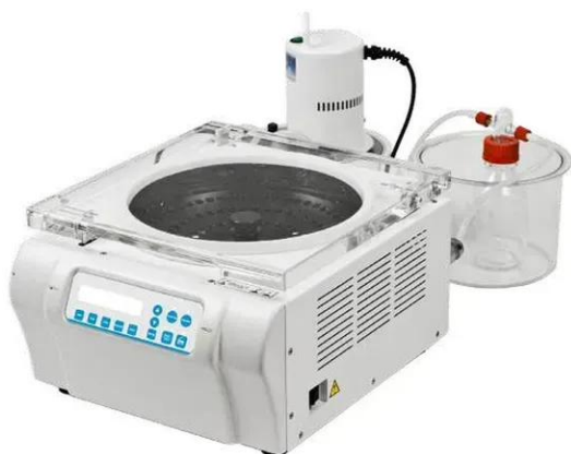
ScanSpeed 32 у системі MiniVac Alpha. Насос та уловлювач замовляють окремо.
